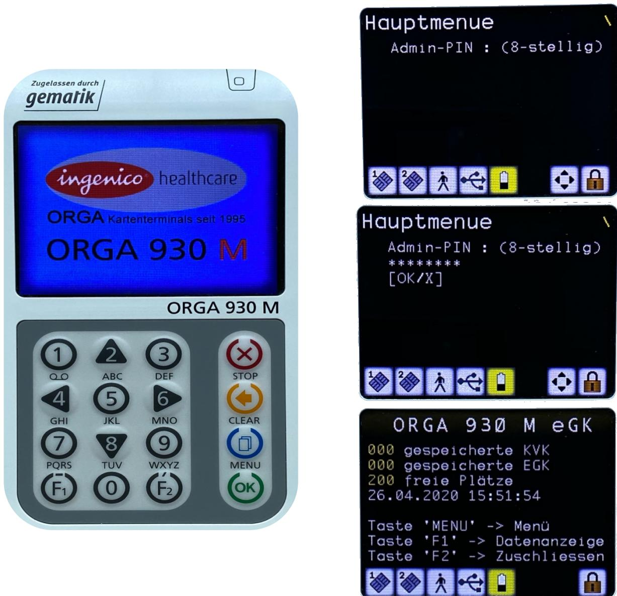
Abbildung 4: Gerät beim Einschalten, Eingabe des Passworts und im betriebsbereiten Zustand
